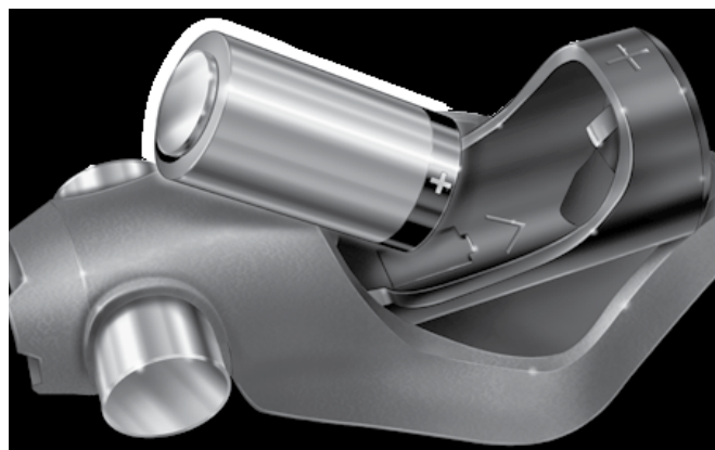
Figura 8 Inserción de baterías (lado positivo primero)
